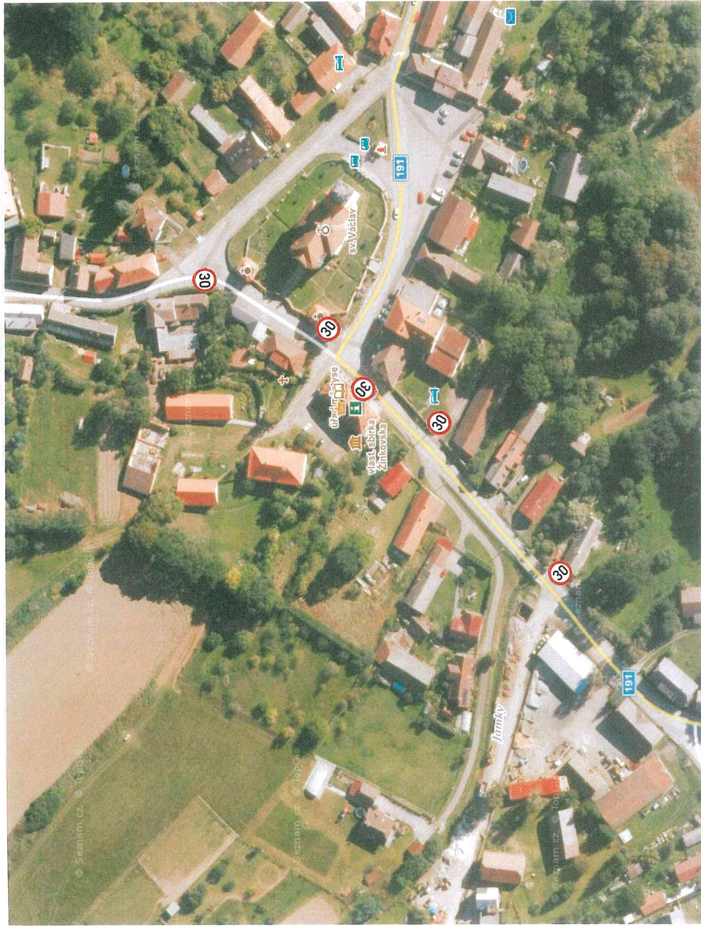
Grafický návrh stanovení místní úpravy provozu na pozemní komunikaci č. II/191 a č. III/19117 v městysi Žinkovy
